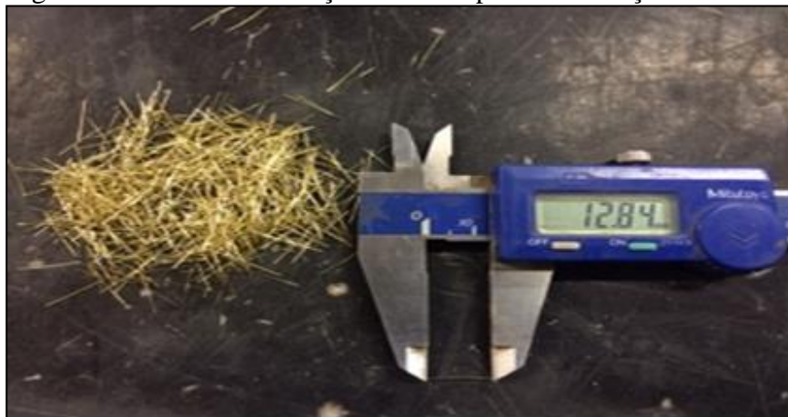
Figura 4 - Microfibras de aço utilizadas para a confecção de CUAD
