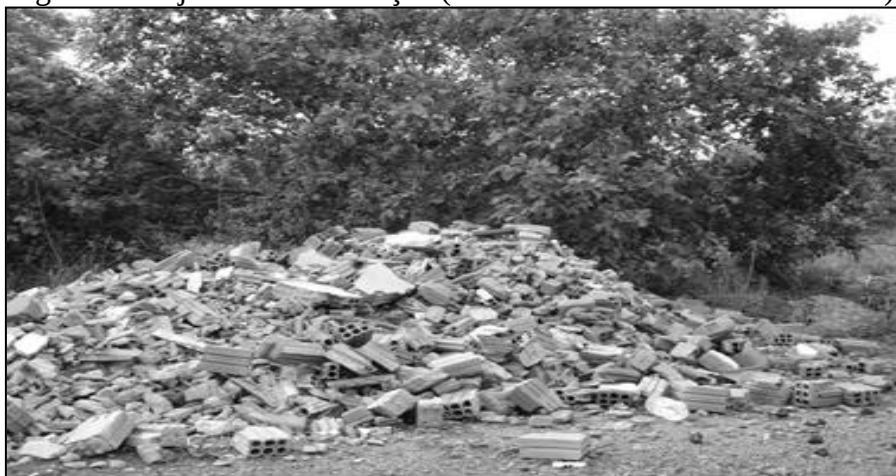
Figura 1 - Rejeitos de construção (materiais cerâmicos e cimentícios).
