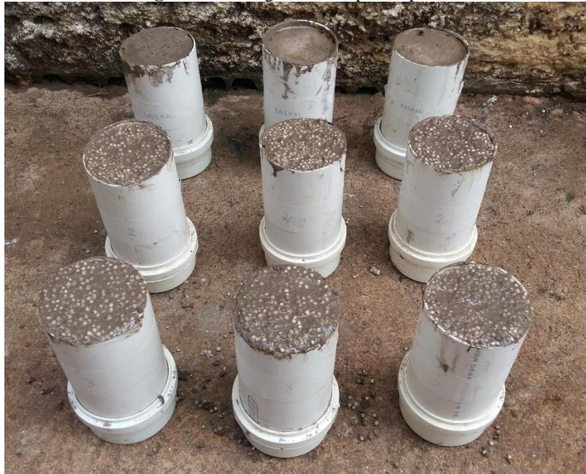
Os corpos de prova foram separados para a retirada dos moldes após 2 dias e foram alocados em um recipiente para cura submersa por um período de 28 dias, conforme ilustrado na figura 3.
