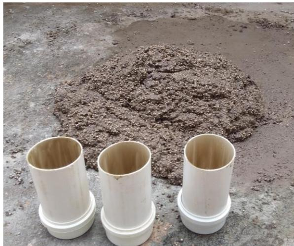
Nesta etapa foi utilizado moldes cilíndricos, conforme mostrado na figura 2, prismáticos com diâmetro de 75 mm por 150 mm de altura. Depois, untamos com óleo para facilitar a retirada dos corpos de prova do seu interior, logo após, foram preenchidos com suas respectivas misturas com diferentes porcentagens de EPS, como veremos a seguir:
