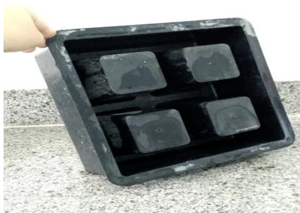
Figura 06 - Forma utilizada para confecção dos elementos vazados.
