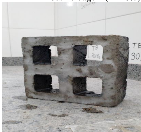
Figura 10 - Elemento vazado após a desmoldagem (TB20%).
