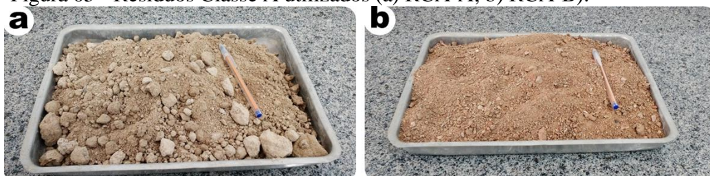
Figura 05 - Resíduos Classe A utilizados (a) RCA-A; b) RCA-B).
